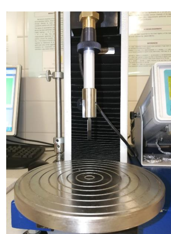
Obrázek 3: TIRA – test pro měření pevnosti výrobků
